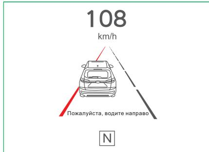
Интерфейс предупреждения комбинированного приборного модуля показан на рисунке выше (автомобиль отклоняется от линии левой полосы движения). Когда автомобиль отклоняется от полосы движения, обнаруженной системой предупреждения об отклонении от выбранной полосы, модуль комбинированного прибора отображает интерфейс предупреждения и отправляет предупреждающий звук о отклонении от полосы движения,
