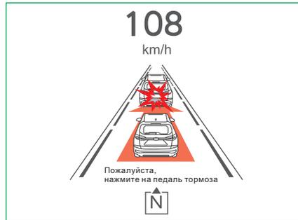
Рычаг предупреждения системы предупреждения о лобовом столкновении разделен на два уровня: предупреждение первого уровня (общий тип) и предупреждение второго уровня (усиленный тип).
