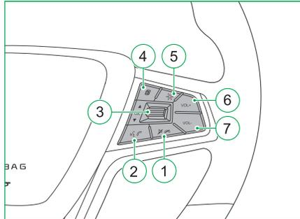
1. Функция использования телефонной связи работает только на моделях, оборудованных Bluetooth и системой распознавания голосов. Нажмите данную кнопку для отключения голосовой системы; во время разговора нажмите данную кнопку для завершения разговора или отмены звонка. Нажмите кнопку для отключения звука при работе мультимедийной системы.
